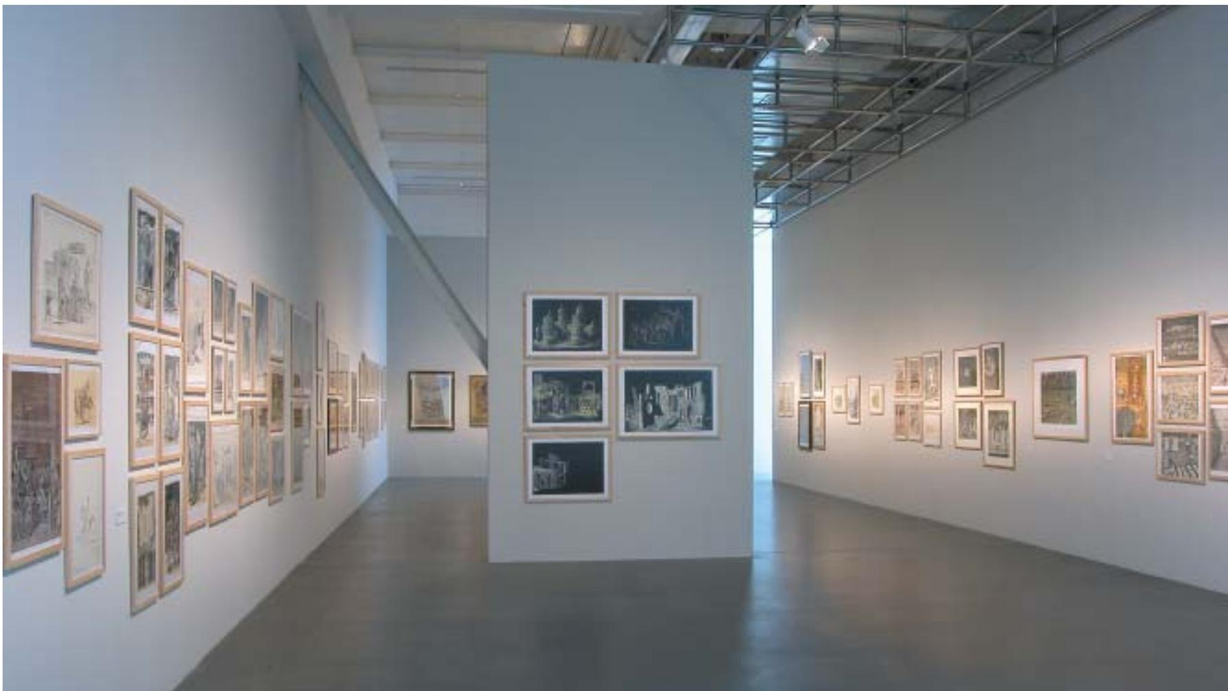
Un particolare della ristrutturazione delle sale espositive: in questa foto sono visibili la nuova pavimentazione, il nuovo soffitto con la griglia tecnica a vista e la parete mobile realizzata appositamente per l'allestimento della mostra di Domenico Gnoli. Foto: Luca Ficini
